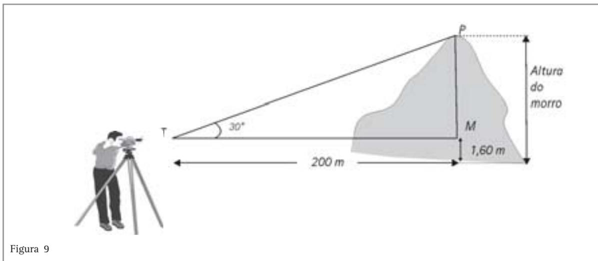
Desejando saber qual a altura do morro que tinha à sua frente, um topógrafo colocou-se com seu teodolito a 200m do morro. Ele sabe que a altura do teodolito é de 1,60m. Posiciona o aparelho que lhe fornece a medida do ângulo de *visada* de parte do morro: 30°. Consulta uma tabela de tangentes e verifica que  $tg 30^\circ = 0,57$ . Assim, no triângulo TPM temos:
